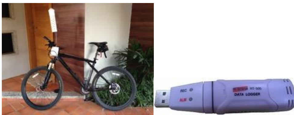
Figura 02 – Bicicleta e dattaloger utilizados para a medição das temperaturas e umidades. Fonte: Própria
