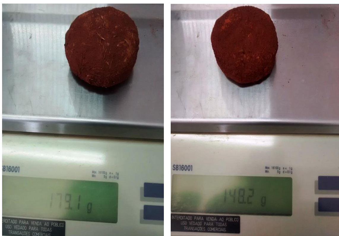
Figura 11 – Teste da resistência seca: bolacha com palha (esquerda) e bolacha sem palha (direita).
