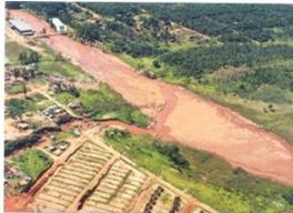
*Inundação, erosão e assoreamento decorrentes de ocupação inadequada de loteamentos*
